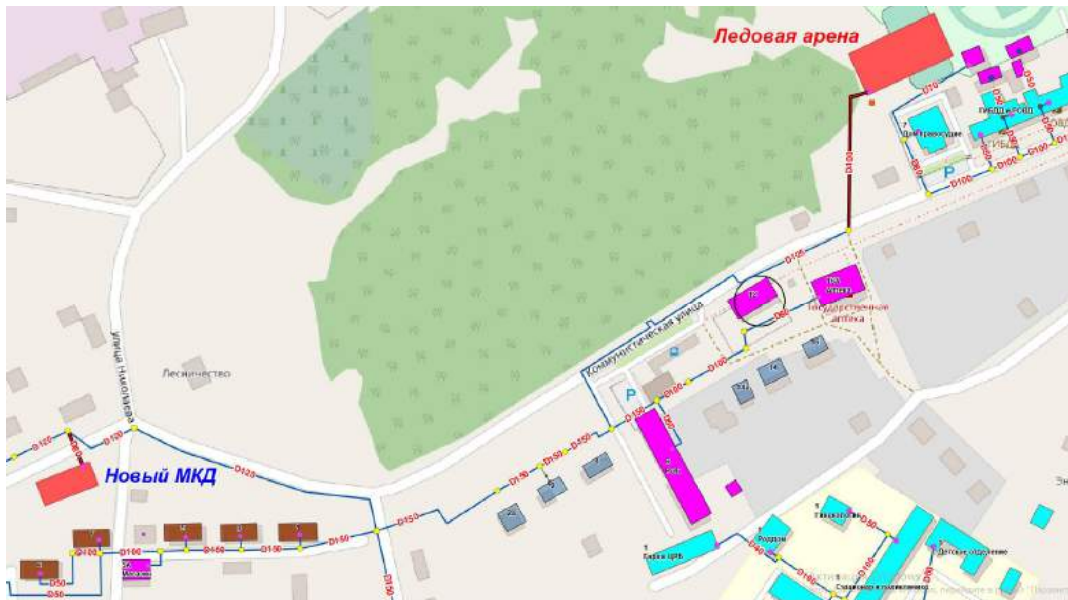
Рисунок 1 Фрагмент схемы сетей теплоснабжения в местах присоединения новых объектов к СЦТ «мкр. №1».
